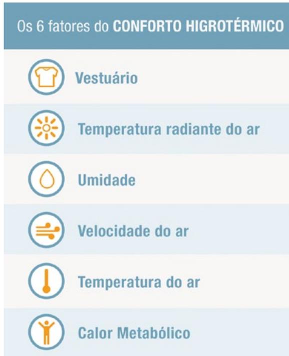
**Figura 16.** Os seis fatores básicos que afetam o conforto higrotérmico
