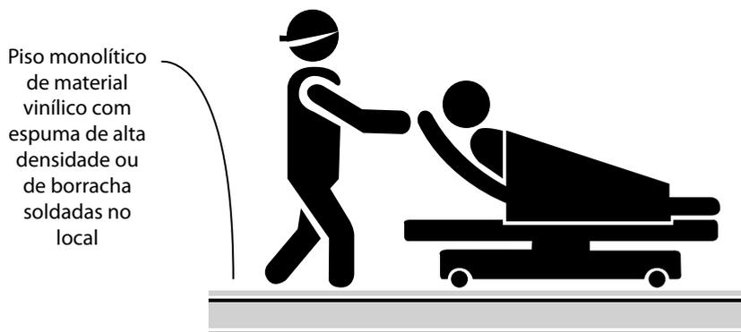
**Figura 30.** Revestimentos de pisos que podem facilitar a circulação, reduzir ruídos e promover o deslocamento confortavelmente
